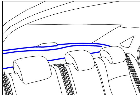
**1** Перед демонтажом штатной полки снимите подушку заднего сидения, тем самым получив доступ к креплению ремней безопасности.
