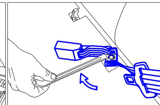
**8** Закрепить ответную часть крепления ремней безопасности. Установить подушку заднего сидения на свое место.
