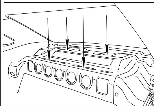
**5** Проклеить места соприкосновения рамы и акустической полки лентами шумоизоляции. Установить в полку динамики.
