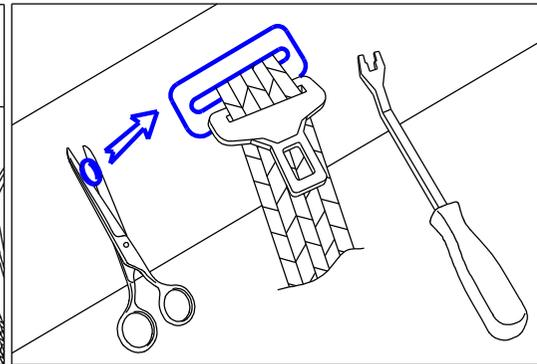
**3** При помощи клипсодера или ножниц извлечь клипсы фиксирующие штатную полку. Извлечь декоративную накладку ремня безопасности.
