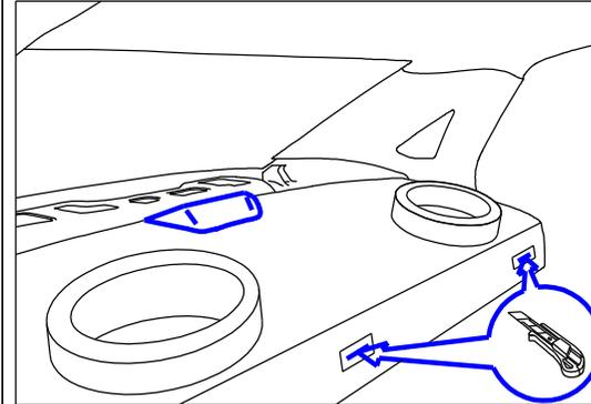
**6** Установить на акустическую полку повторитель стоп-сигнала. Сделать прорезы в окошках и пропустить сквозь них ремни безопасности.
