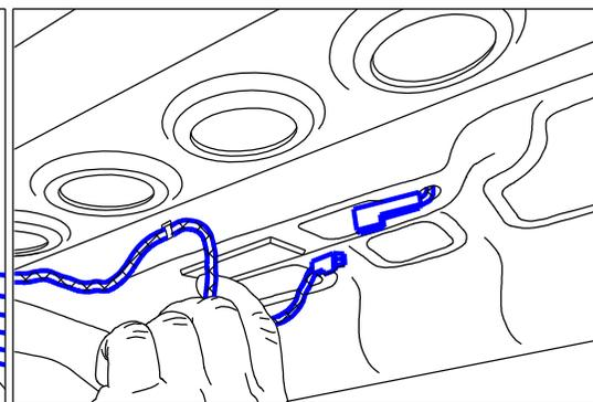
**4** Отсоединить колодку повторителя стоп сигнала. Извлечь штатную полку из салона автомобиля.
