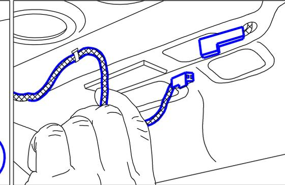
**9** Из багажного отсека зафиксировать при помощи шурупов сквозь технологические отверстия акустическую полку. Подсоединить разъем повторителя стоп-сигнала.
